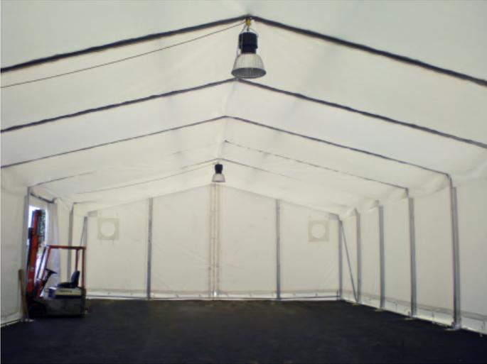
Besonders bei einem wasserdurchlässigen Untergrund (Schotter etc) oder bei einer Wasserablauffrinne im Zelt kann sich Kondenswasser bilden
